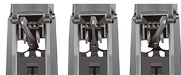
●マガジンセレクターレバー（実銃） レバーを左右に動かす事で左右のマガジンを選択する。中央の場合はマガジンがロックされ、チェンバーに直接装填およびシェルの取り出しができる。
